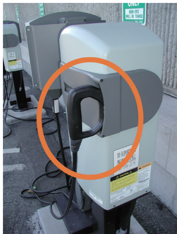
GM が採用していた充電方式のインダクティブ・チャージャー
